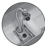
牛ビック80N-1・横下配管 ステンレス製 幅340×カップ深さ140×奥行436.5mm 重量: 5.3kg ヒーター: 単相200V-500W 設定温度: 30℃ (OFF) 復帰温度: 20℃ (ON) フレキシブルパイプ 40cm フレキシブルベルトヒーター付属
