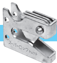
スーパーロックS(3枚錠) ステンレス製 (SUS304) 幅17×高さ55×奥行72mm 穴ピッチ30mm
